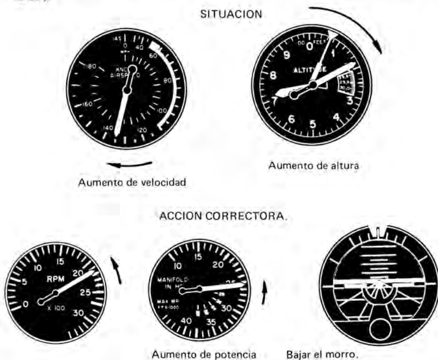
Fig. 39. – Situación de ganancia de velocidad y altura simultáneas.
