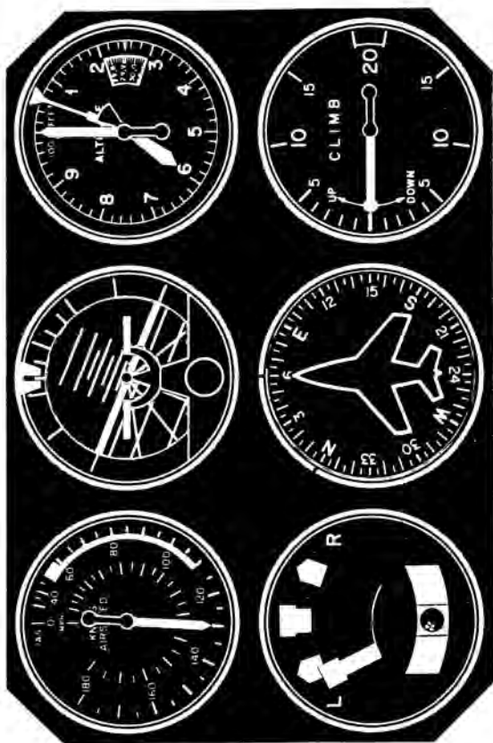
Fig. 85. - Aspecto que presenta el panel en un viraje estandar cuando se ha detectado un error en la indicación del bastón. Observemos como el bastón está fuera de la "cruce del perro".
