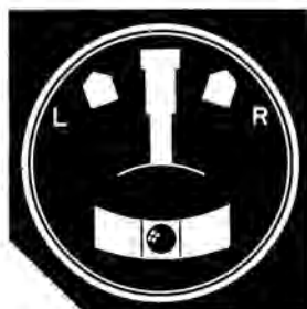
Fig. 103. — Centrar el bastón con el volante, hacia el lado contrario de donde indica. Centrar la bola con los dos pies. "Pisar la bola".
