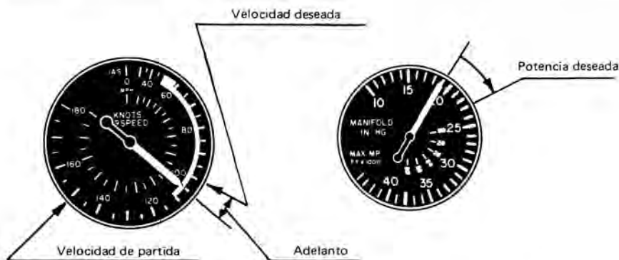
Fig. 100. — Un poco antes de alcanzar la velocidad deseada deberá realizarse un ajuste adecuado de la potencia.
