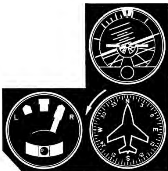
Fig. 26.— Instrumentos que deben utilizarse para el control de inclinación.
