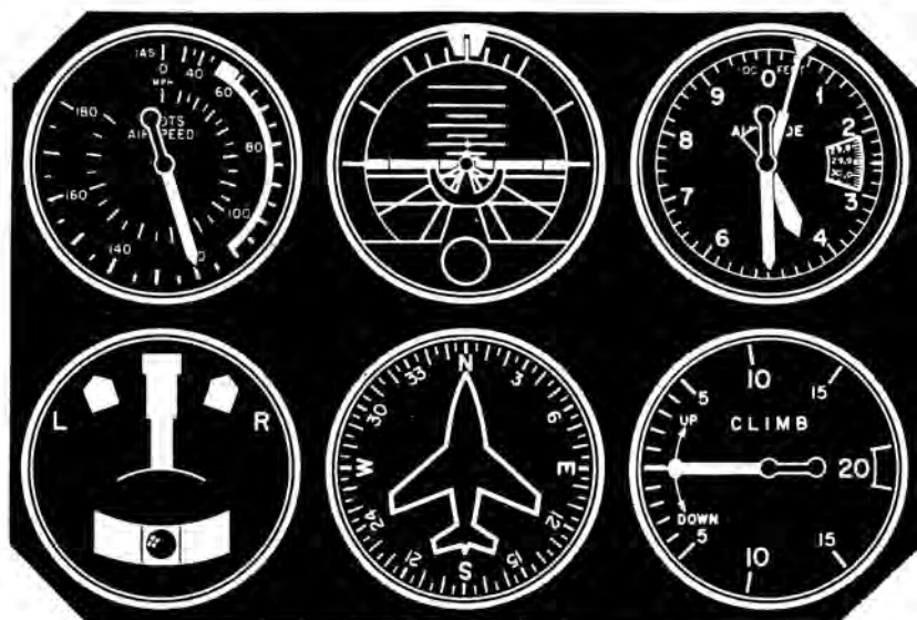
Fig. 48. — Aspecto del panel en la posición de vuelo recto y nivelado.
