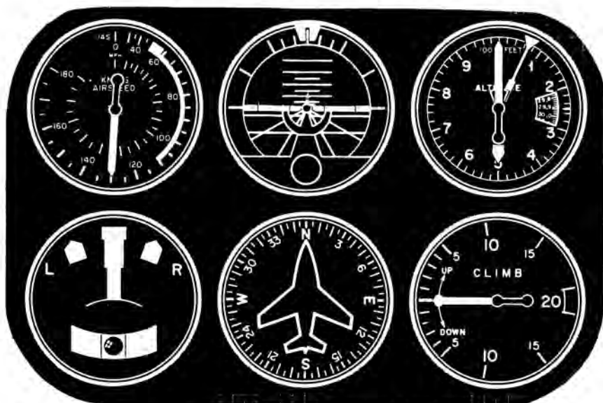
Fig. 15.— Posición de instrumentos a velocidad normal. Observar el horizonte “barra en el horizonte” y el anemómetro en indicación de velocidad normal.
