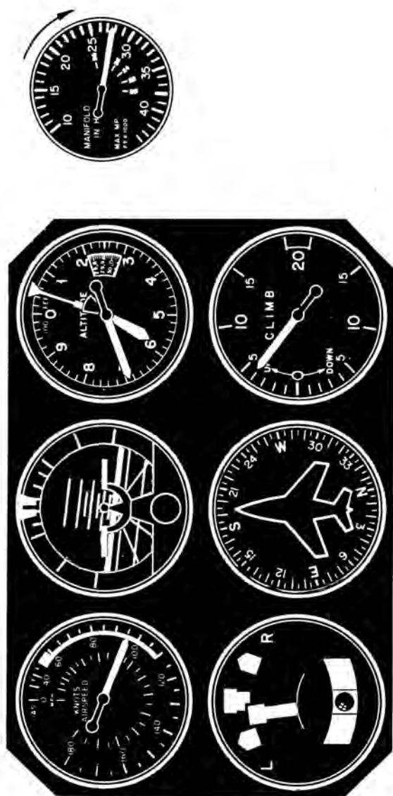
Fig. 92. — Aspecto que presentará el panel cuando se ha conseguido lograr dominar la situación y se intenta llevar el avión a la posición anterior que tenía antes de producirse.
