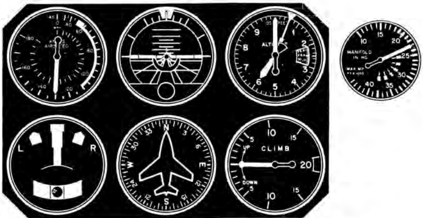
Fig. 81 (bis).— Obsérvese como después de recuperado el viraje es necesario reducir la potencia del motor al haberse producido un aumento de sustentación.
