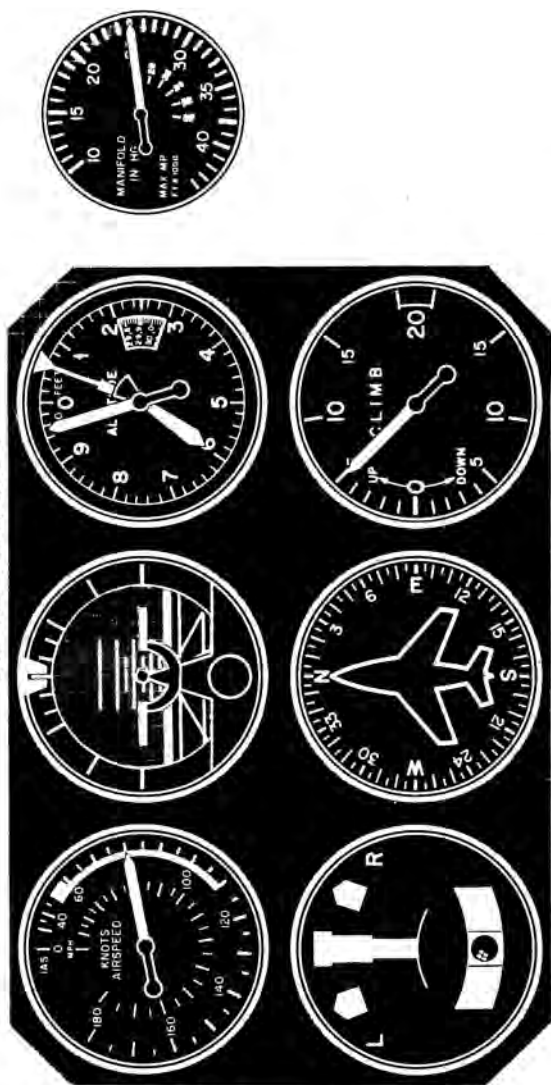
Fig. 62.- Aspecto del panel durante la maniobra de ascenso a régimen constante de 500 pies. Obsérvese la potencia del motor en 25" como se requiere para mantener 80 m.p.h.
