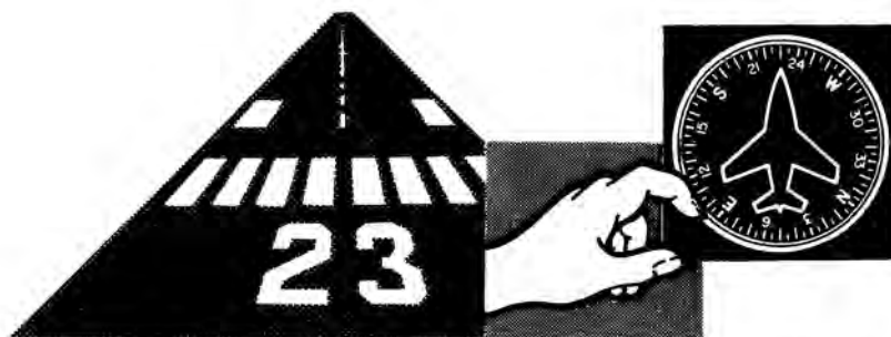
Fig. 111. — Ajustar el direccional exactamente con el rumbo de la pista publicado.
