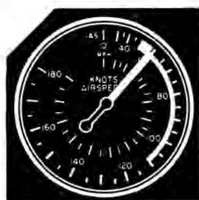
Fig. 102. — Mover el volante hacia adelante para evitar que el anemómetro siga perdiendo velocidad.
