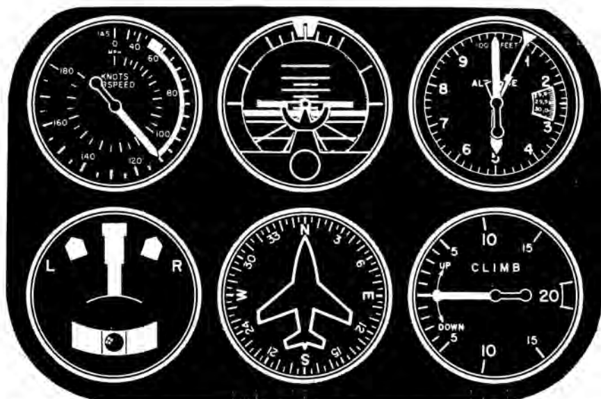
Fig. 14.— Posición de instrumentos a baja velocidad. Observar el horizonte “barra por encima” y en anemómetro en indicación de baja velocidad.
