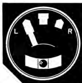
Fig. 82.— Establecer el viraje cuando el segundero pasa por las señales 12, 3, 6 ó 9.
