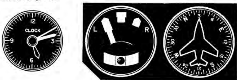
Fig. 84.— Se puede comprobar que el régimen de cambio de rumbo es correcto si cada 10" se cambia el rumbo 30°.
