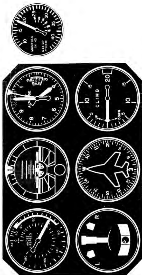
Fig. 42. — Presentación del panel en la situación de vuelo recto y nivelado a 100 m.p.h. de velocidad.
