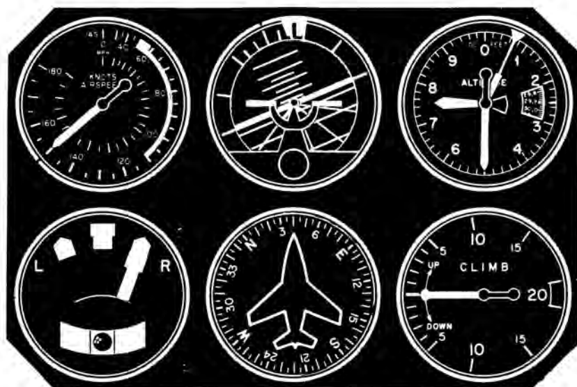
Fig. 95. – Aspecto del panel en un viraje durante el cual se cambia simultáneamente la velocidad. Recordemos que el ángulo de inclinación, para mantener un viraje estándar, deberá irse modificando al cambiar la velocidad.
