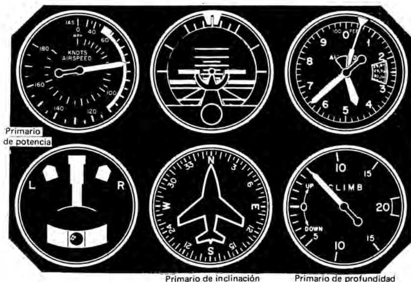
Fig. 57.— Presentación del panel en una situación de ascenso a 500 pies de variómetro (régimen constante) y 80 m.p.h. de velocidad.
