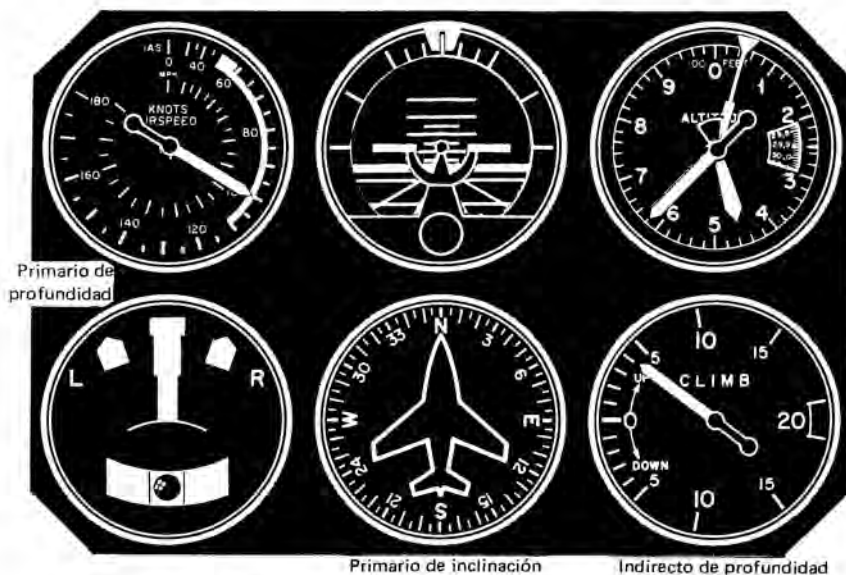
Fig. 53.— Obsérvese la posición del panel con los instrumentos estabilizados en la posición de ascenso. Solamente el altímetro se mueve indicando ascenso.
