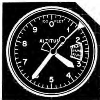
Fig. 19. – Mover el control de profundidad para detener el movimiento de la aguja. El altímetro de la figura indica 13.600 pies.
