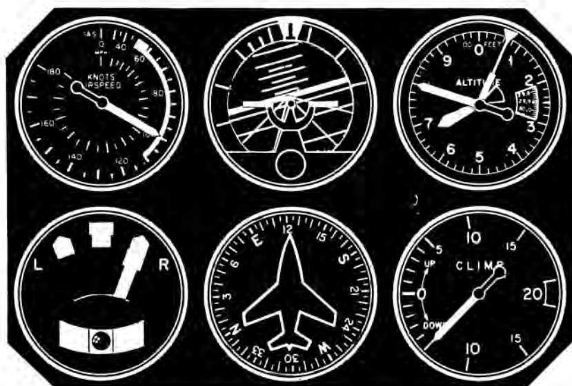
Fig. 94.— Viraje descendente. También aquí la comprobación de instrumentos deberá ser muy rápida. Obsérvese que la velocidad del anemómetro es mayor que en el caso anterior. Normalmente los descensos se hacen a mayor velocidad que los ascensos.
