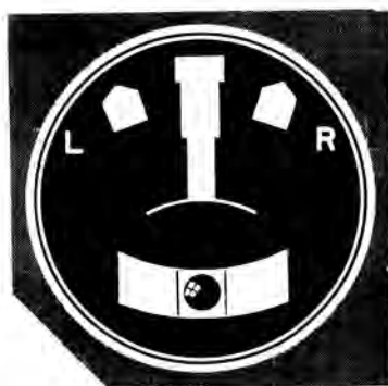
Fig. 6. — Inclinómetro. Bastón y bola
