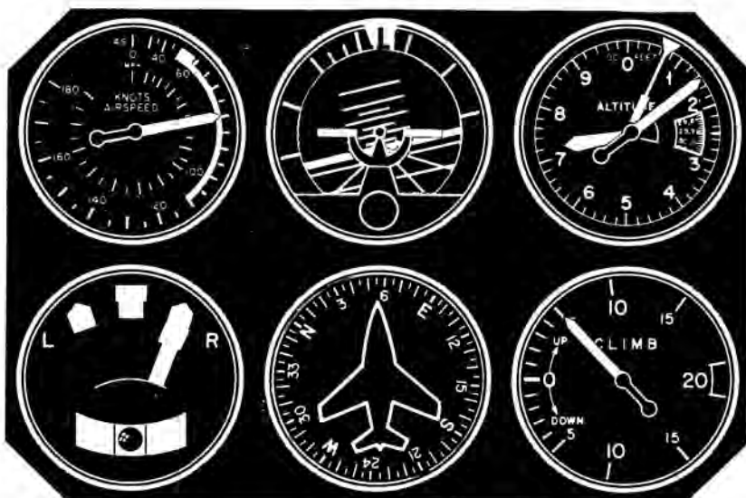
Fig. 93.— Viraje ascendente. La comprobación de instrumentos deberá ser muy rápida, pues prácticamente todos los instrumentos tenderán a moverse.
