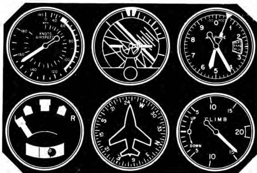
Fig. 88.— En el picado en espiral el ángulo de inclinación y la posición del morro se han desequilibrado. El ángulo de inclinación se ha escapado por delante de la posición del morro.
