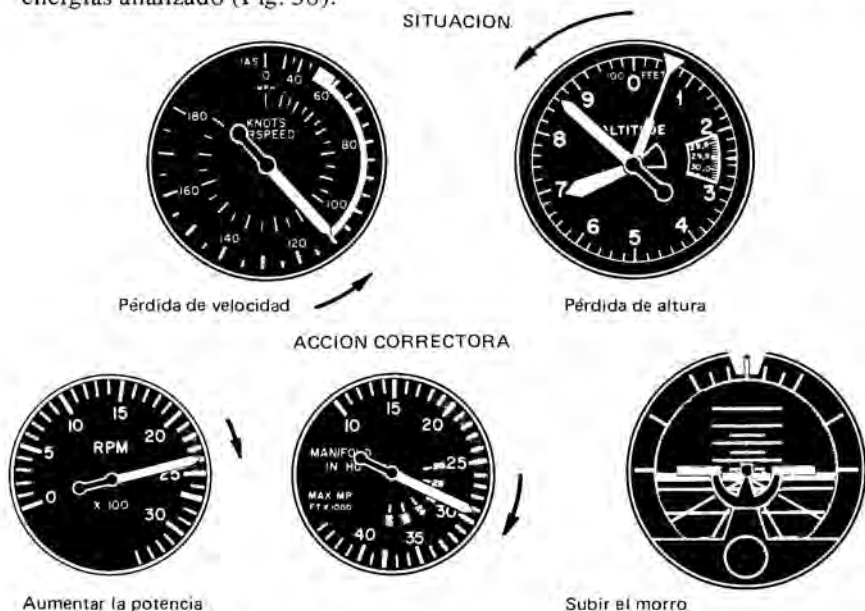
Fig. 38. – Situación de pérdida de velocidad y de altura simultáneas.
