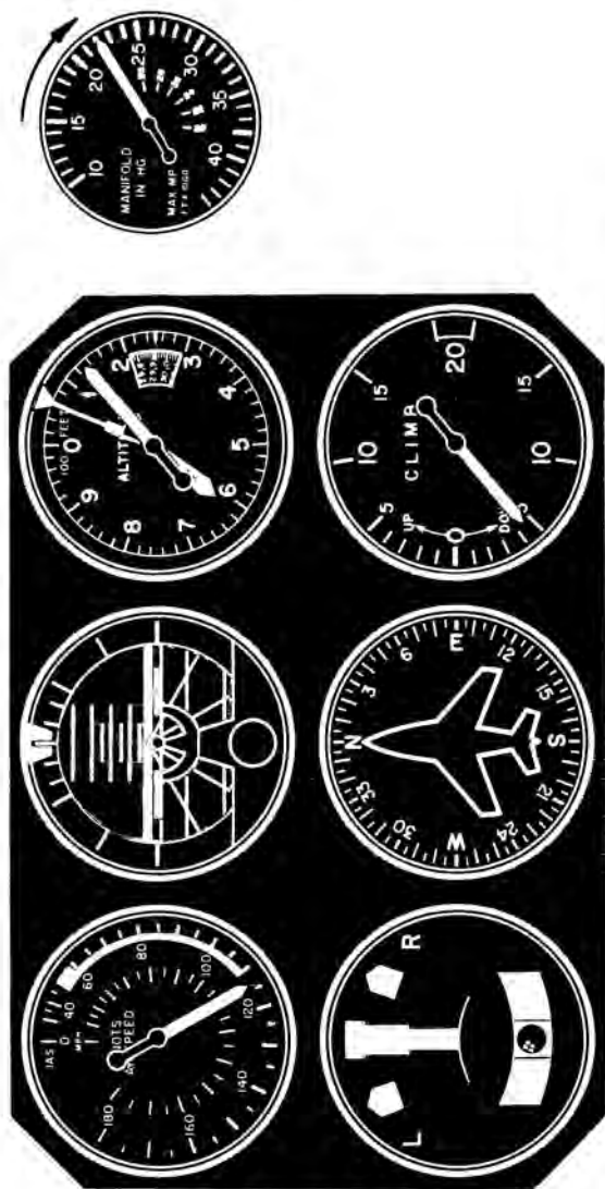
Fig. 71.— Aspecto que presenta el panel en el momento siguiente a iniciar la nivelación. Obsérvese el aumento de potencia y el aumento de velocidad como consecuencia. El régimen de variómetro disminuye progresivamente.
