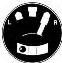
Derrape a la derecha.
