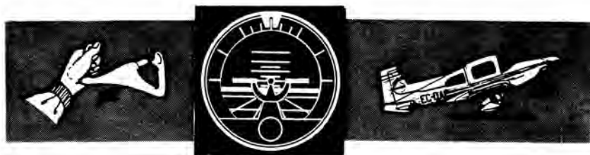
Fig. 116.— Cuando la velocidad sea de 15 a 20 m.p.h. por debajo de la de despegue, tirar ligeramente del volante hacia atrás.
