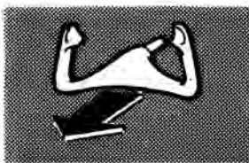
Fig. 108.— Levantar el morro "suavemente" para colocarlo en situación de vuelo horizontal. Se puede detectar esta situación por la estabilización del anemómetro y la detención del altímetro. Si se tira con violencia del volante se pueden producir daños estructurales al sobrepasar el número de "g" que puede aguantar el avión.
