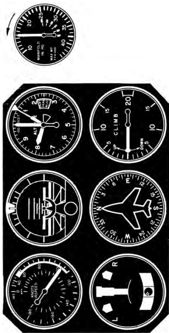
Fig. 67. — Alcanzada la velocidad deseada, o muy próximos a ella reducir el motor a la potencia adecuada de descenso.
