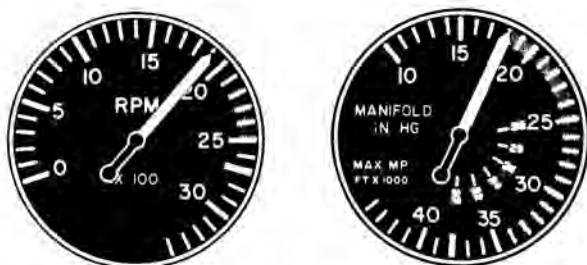
Fig. 65.— Reducir el motor a la potencia seleccionada. Normalmente los descensos se hacen a una velocidad menor que la de crucero.
