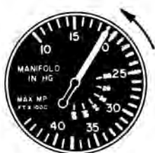
Fig. 55.— Aspecto que presentan los instrumentos al pasar a un ascenso a menor velocidad.
