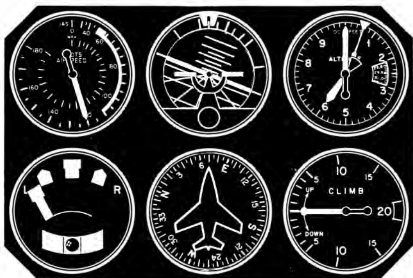
Fig. 87. — Obsérvese que en esta figura sólo se establecen 20° de inclinación y sin embargo se considera viraje fuerte. La razón es que la velocidad que se está manteniendo es de sólo 120 m.p.h.
