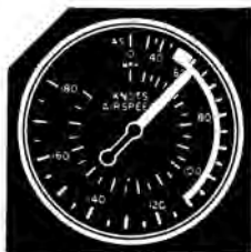
Fig. 119. – Bajar ligeramente el morro, pero sin permitir que el variómetro indique descenso. Permitir que el avión se acelere para alcanzar la velocidad de retracción de flaps. Comprobar en el anemómetro que el avión ha entrado en la zona de velocidades en las que es posible el vuelo sin los flaps extendidos.
