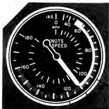
Fig. 52.— Aumentar la potencia a la necesaria para mantener la velocidad, aproximadamente un 10 por ciento antes de la velocidad de ascenso.
