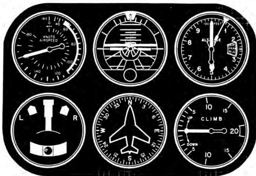
Fig. 16.— Posición de instrumentos a alta velocidad. Observar el horizonte “barra por debajo” y el anemómetro con indicación de alta velocidad.
