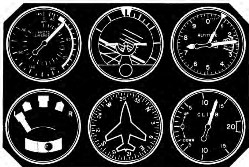
Fig. 101.— Aspecto que presentará el panel en una posición anormal de “morro alto”. El anemómetro pierde rápidamente velocidad, la posición del morro en el horizonte artificial es muy alta, el altímetro gana altura rápidamente, el variómetro también indica una rápida ganancia de velocidad vertical ascendiendo el direccional indica cambios de rumbo muy rápidos, el bastón indica inclinación hacia el mismo lado que el horizonte. La bola puede estar en cualquier sitio, ya que no es indicativa por estar sometida a fuerzas tangenciales que inducen al avión a derrapar o resbalar.
