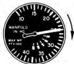
Fig. 56.— Realizar el ajuste en profundidad simultáneamente con el mando de potencia.
