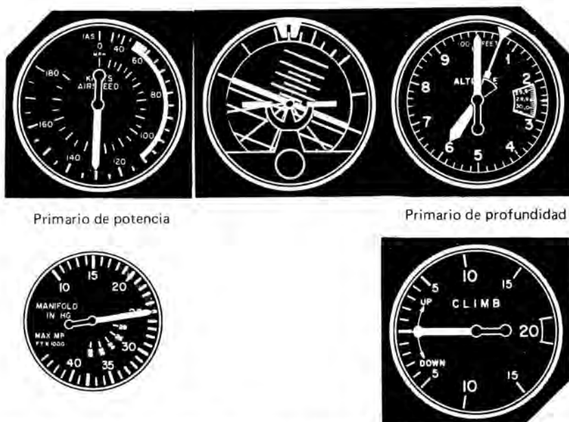
Fig. 77.— Aspecto del panel durante el viraje. Al mantener constante la altura, el avión pierde sustentación y para mantener la velocidad será necesario aumentar la potencia. El anemómetro se convierte así en el primario de potencia.
