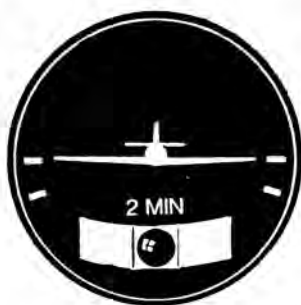
Fig. 6. — Inclinómetro. Bastón y bola
