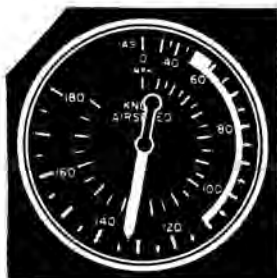
Fig. 108.— Levantar el morro "suavemente" para colocarlo en situación de vuelo horizontal. Se puede detectar esta situación por la estabilización del anemómetro y la detención del altímetro. Si se tira con violencia del volante se pueden producir daños estructurales al sobrepasar el número de "g" que puede aguantar el avión.
