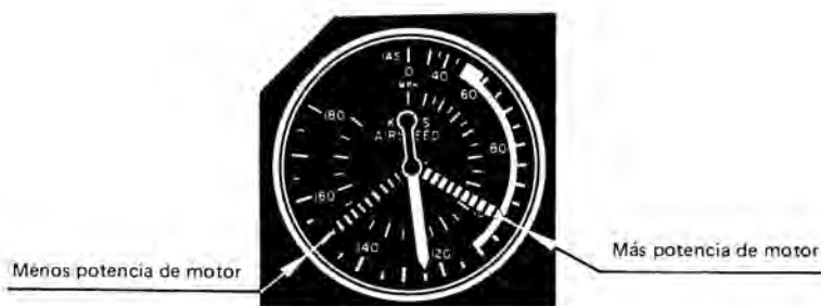
Fig. 97.— El indicador de velocidad será el primario de potencia.
